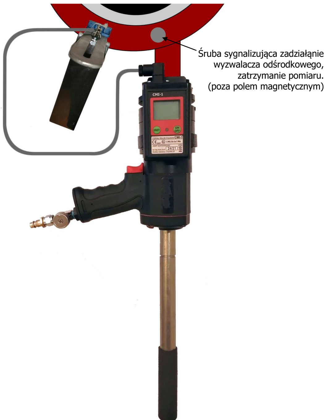
Rys. nr 2b. Cyfrowy miernik obrotów CMO-3/S – usytuowanie sondy magnetycznej względem śruby wyzwalającej po zadziałaniu wyzwalacza – koniec pomiaru (Dźwignia poza polem magnetycznym).
