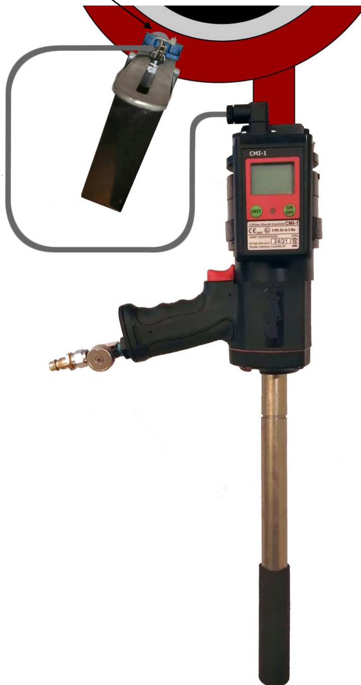
Rys. nr 2a. Cyfrowy miernik obrotów CMO-3/S – usytuowanie sondy magnetycznej względem śruby wyzwalającej w trakcie pomiaru (głowica w bezpośrednim kontakcie z śrubą)
